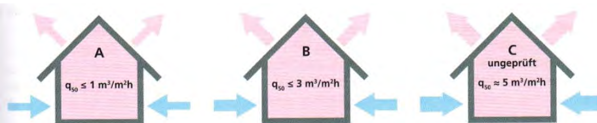
Abb. 1: Klassifizierung der Luftdichtheitsklassen (LDK) nach Fraunhofer Institut für Bauphysik
