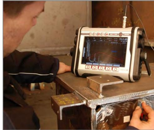
Ultraschallgerät für die zerstörungsfreie Schweißnahtprüfung (Innovationspreis des Landes Sachsen-Anhalt 2013)
