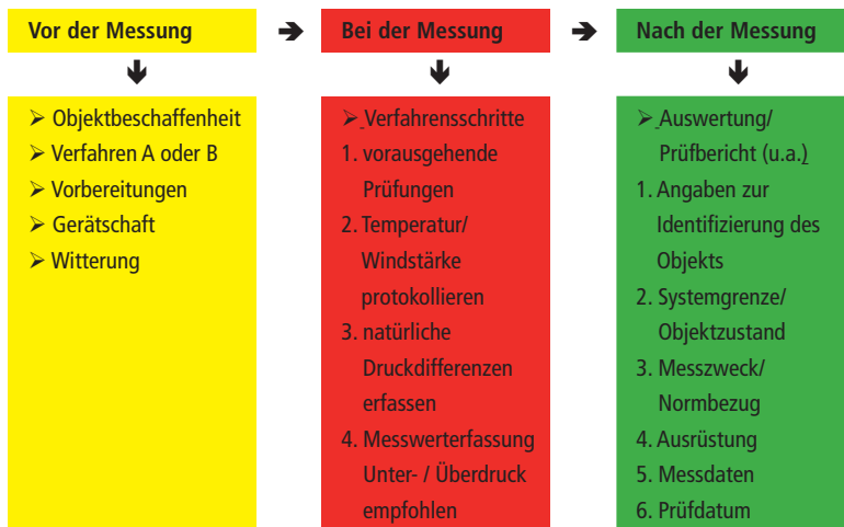
Abb. 3: DIN EN 13829 gibt den Weg für eine Schlussmessung vor
