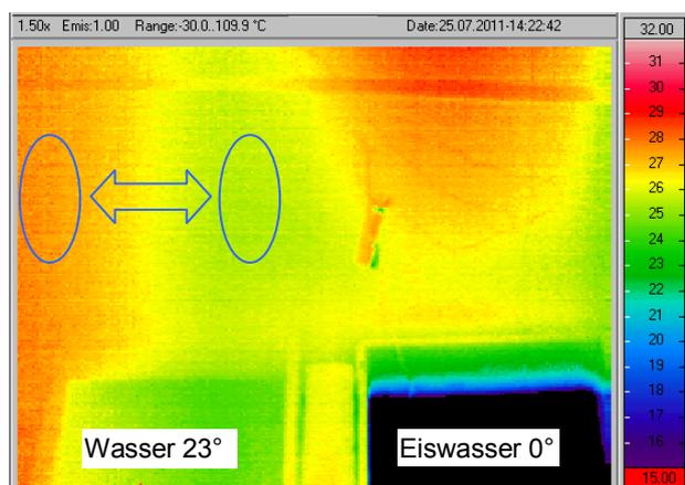
**Bild 6-20:** IR Bild (Mikobolometer). Hier ist die Instabilität innerhalb des Bildes gut erkennbar (nach 50 Min. ohne Abgleichen). Die Wandtemperaturen waren zu Messbeginn gleich!  $\leftrightarrow$
