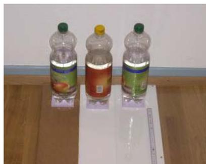
**Bild A-11:** Fotos zu den IR-Bildern. Glas spiegelt auch im sichtbaren Bereich, je kleiner der Winkel, desto stärker die Spiegelung.
