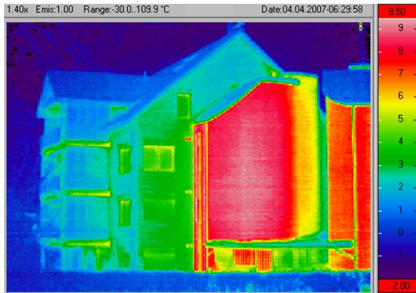
**Bild 4-3:** Betonwände können auch nach vielen Stunden noch weit weg vom quasistationären Zustand sein, vgl. Temperaturgrafik unten.
