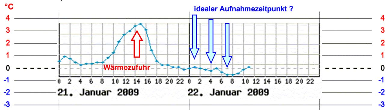
**Bild 4-7:** Temperaturverlauf: Wann ist der ideale IR-Aufnahmezeitpunkt?
