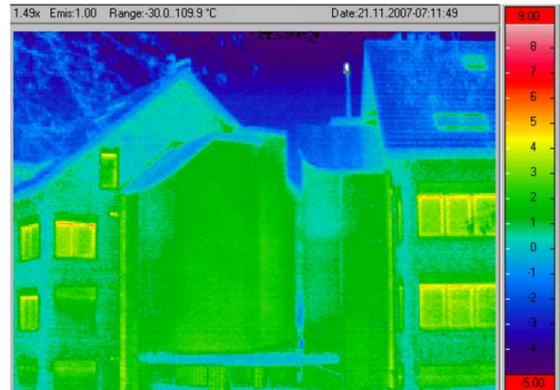
**Bild 4-4:** Gleiches Gebäude, wie links. Hier jedoch mit guten IR-Randbedingungen auch am Vortag, vgl. Temperaturgrafik unten.
