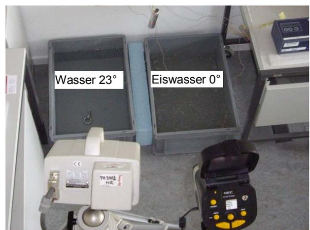
**Bild 6-21:** Foto des Driftversuches: Links unten der Scanner TH 3102, rechts die IR-Kamera TH7700 mit dem Mikrobolometer (Details siehe Anhang A4) Oben rechts: Kontrolle mit Thermoelement-Logger.
