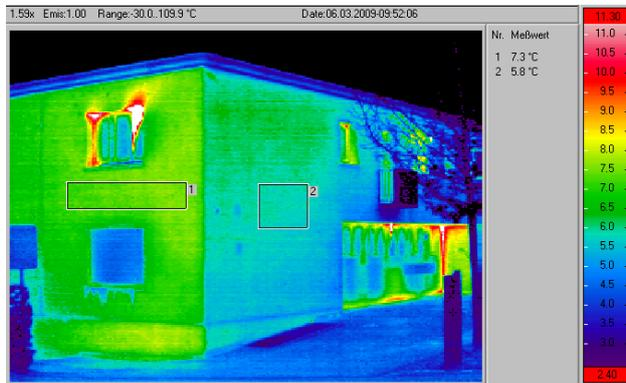
**Bild 4-10:** IR Aufnahme am 06.03.2009, 09:52 h ca. 3 h nach Sonnenaufgang. Es herrscht seit 2 Tagen Hochnebel ohne direkte Sonneneinstrahlung. Diffusstrahlung =  $141 \text{ W/m}^2$
