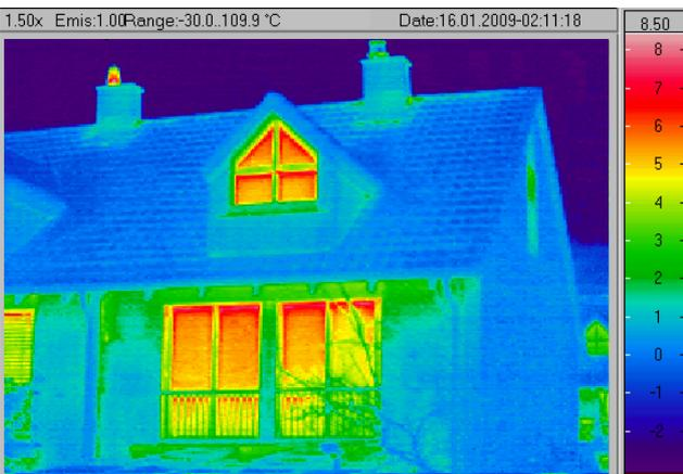
Auch die IR-Bilder 3 und 4 (unten) zeigen neue Fenster. Dort ist knapp erkennbar, dass die  $\rightarrow$  rotgelben Linien primär vom Glasrandverbund stammen. Mit mehr Distanz verschwindet diese Information und es zeigt sich nur noch eine erhöhte Rahmentemperatur. (Distanz-Effekt: vgl. Anhang 7).
