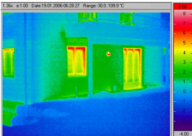
Das IR-Bild links zeigt das gleiche Phänomen unter einem Balkon. Auch bei vertieften Hauseingängen, in Gebäudenischen und beim Fenstersturz etc. sind deshalb die Temperaturen meist etwas erhöht. Das erschwert zwar die Bildinterpretationen etwas, die effektiven wärmetechnischen Schwachstellen sind aber trotzdem erkennbar.
