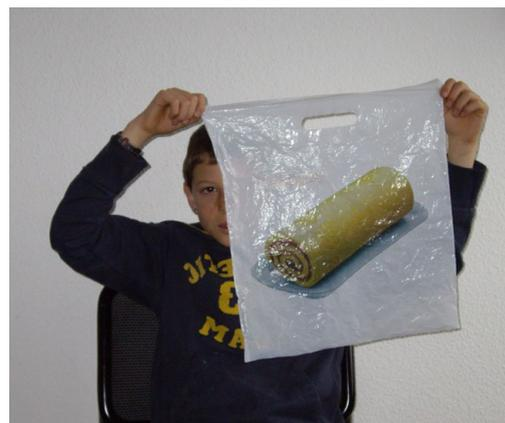
Gerade umgekehrt verhält sich die Situation bei den meisten Kunststofffolien oder z.B. auch bei Rauch. Diese sind im optischen Bereich undurchsichtig, lassen aber die IR-Strahlung zum grossen Teil durch. Mit zunehmender Dicke der Kunststoffe wird jedoch auch der IR-Strahlungsdurchlass reduziert.
