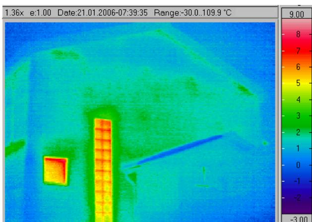
IR-Bild unten: Glasbausteine die Licht in ein Treppenhaus bringen. Im Gegensatz zu den hohen äusseren Oberflächentemperaturen zeigen sich innen entsprechend tiefe Oberflächentemperaturen. Dies kann je nach Innenraumklima (Raumtemperatur und Luftfeuchtigkeit) auch zu Schimmelpilzbildung führen, meist beginnend bei den unteren Mörtelfugen und in den Ecken.
