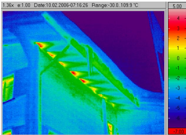
Aber nicht nur die Temperaturen und der Wind, beeinflussen diese Warmluftverluste, sondern auch die Art und die Lage der Leckstellen sowie die Raumgeometrie und das Benutzerverhalten. Wenn die ausströmende, warmfeuchte Innenluft auf dem Weg nach aussen irgendwo in der Konstruktion kondensiert, so besteht ein erhebliches Risiko für Bauschäden.
