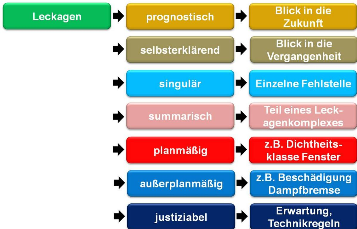
Abbildung 11: Parameter der Leckagebewertung/Leckagebeurteilung – Teil 5 (Einzelsprache von Leckagen – Mikrobetrachtung 2).
