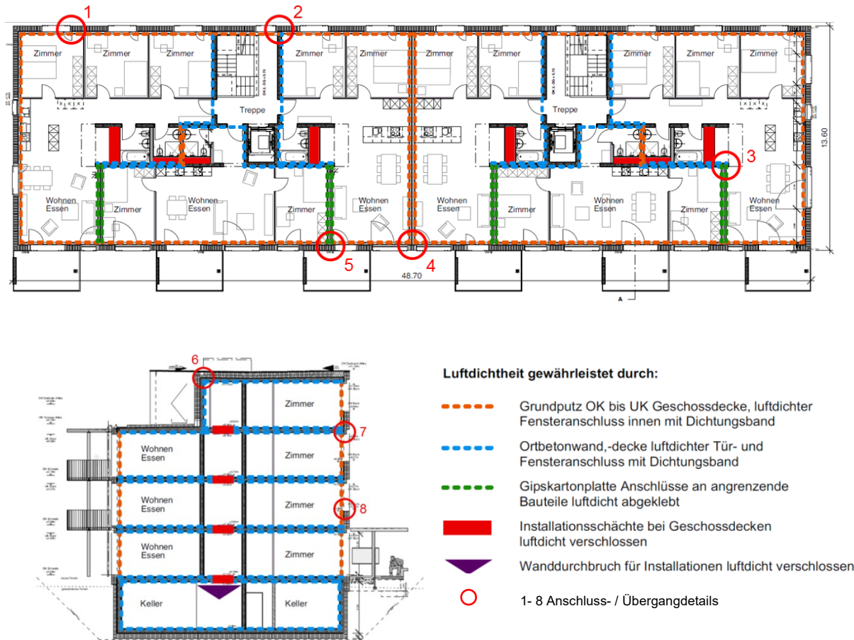
Abbildung 6: Grundriss mit eingetragenen Massnahmen zur Luftdichtheit (Quelle: Planunterlage durch Flumroc AG zur Verfügung gestellt).
