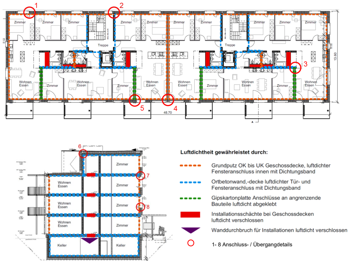
Abbildung 5: Oben: Grundriss mit eingetragenen Massnahmen zur Luftdichtheit. Unten links: Schnitt mit eingetragenen Massnahmen zur Luftdichtheit. Unten rechts: Legende der Massnahmen. Quelle: Minergie-A-Musterantrag (Quelle: Musterantrag Minergie-A;2017)
