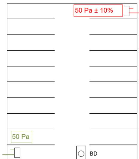
Abbildung 26: Grafik Überprüfung der Druckdifferenz zwischen innen und aussen in den kritischen Zonen; Beispiel Gebäudedruckdifferenz von 50 Pa am Einbauort der Messeinrichtung
