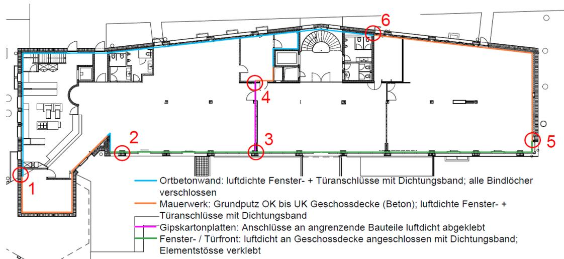
Abbildung 5: Grundriss mit eingetragenen Massnahmen zur Luftdichtheit. (Quelle: Planunterlage durch Flumroc AG zur Verfügung gestellt).
