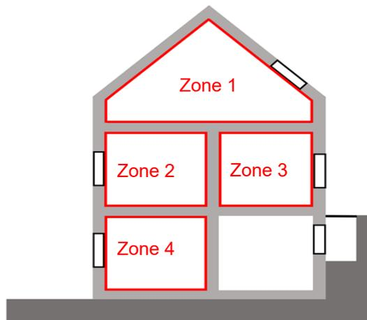
Abbildung 13: MFH mit 4 Nutzungseinheiten. In MFH muss jede Nutzungseinheit (Wohnung, Gemeinschaftsraum, etc.) gegenüber den anderen Nutzungseinheiten luftdicht sein. Dies gilt auch für Treppenhäuser, die aber selten als separate Zone gemessen werden.
