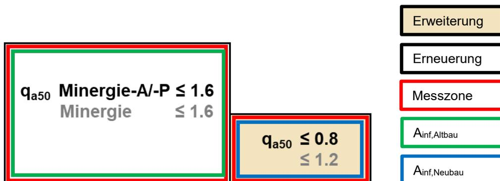
Abbildung 16: Separate Messungen von Erneuerung und Erweiterung als Systemskizze. Z.B. in sich abgeschlossener Anbau
