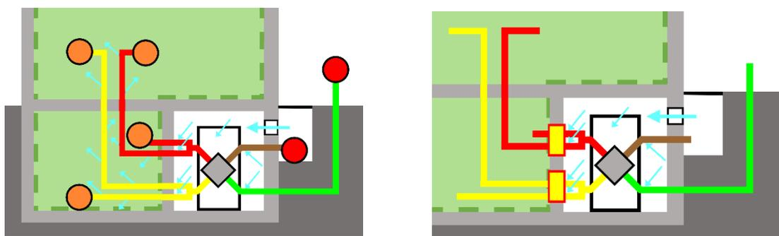
Abbildung 25: Links: Luftumgehungen (Situation während Leckageortung bei Unterdruck) entstehen durch alle nicht hermetisch abgedichteten Rohrverbindungen. Rechts: Nur eine totale Abschottung bei der Luftdichtheitsebene (am besten in der Bauphase) verhindert Luftumgehungen.
