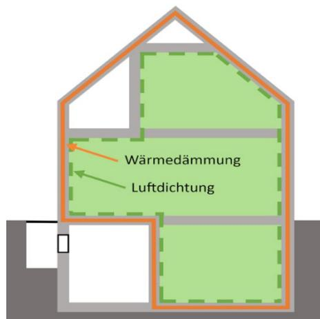
Abbildung 12: Bei älteren EFH ist zu klären, wo der Luftdichtheitsperimeter verläuft.
