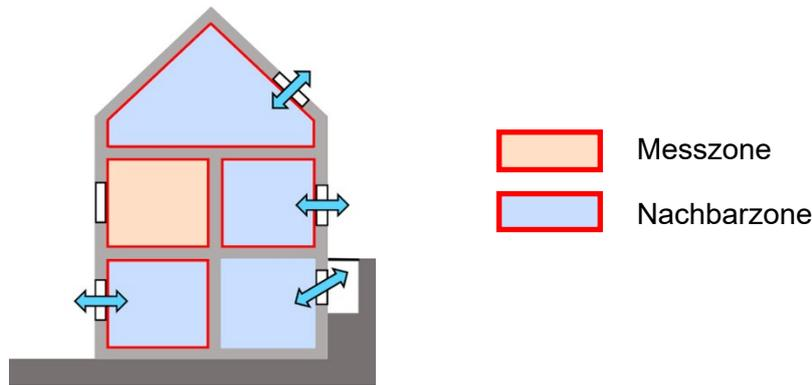
Abbildung 21: Messung einer Nutzungseinheit (Wohnung) in einem Gebäude (MFH). Die Fenster der Nachbarwohnungen, des Treppenhauses und in unbeheizten Nebenräumen sind zu öffnen.
