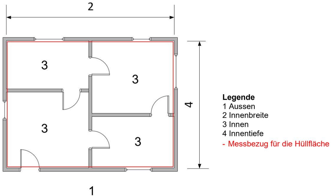
Abbildung 19: Grundriss mit Darstellung der Gesamt-Innenabmessungen (Quelle: SN EN ISO 9972; 2015)
