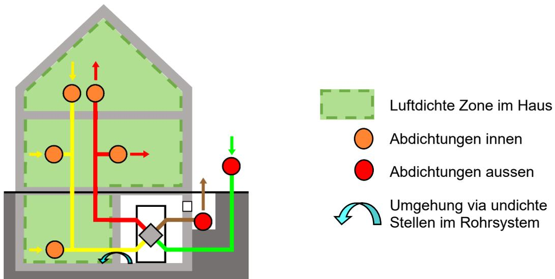
Abbildung 24: Mögliche provisorische Abdichtungen bei Lüftungsanlagen
